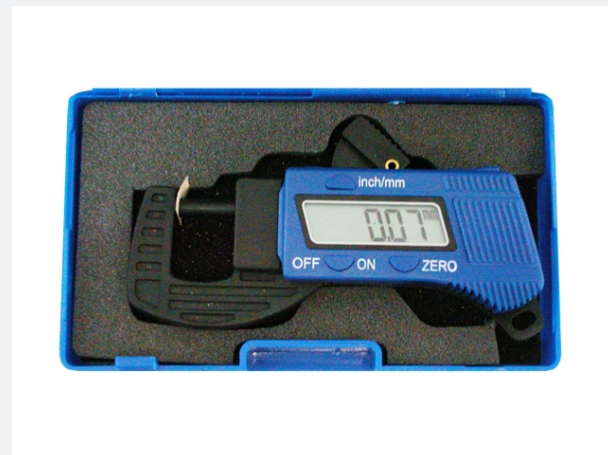
Рис.17. Микрометр - прибор для измерения толщины
