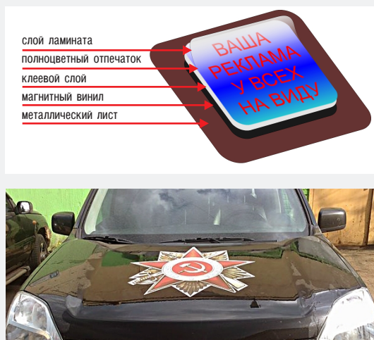
Рис. 17. Структура магнитной наклейки и пример использования на кузове автомобиля
