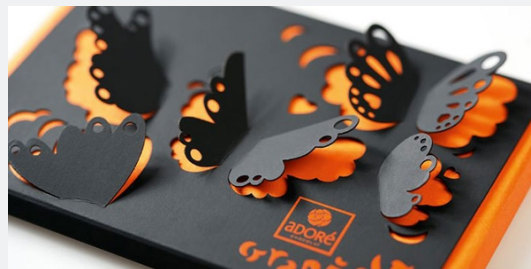
Рис. 15. Лазерная резка как замена вырубки
