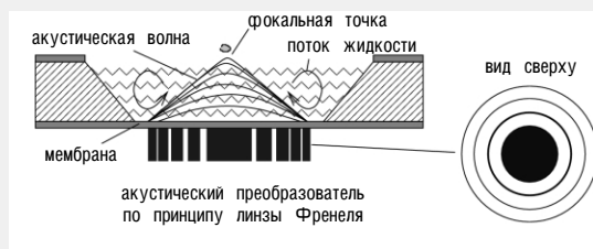
Рис. 9. Импульс акустических колебаний в жидкости фокусируется на поверхности и приводит к отрыву капли, которая преодолевает поверхностное сопротивление.
