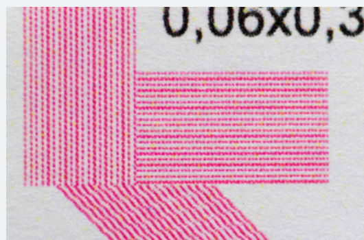
Рис. 2. Canon CLC3220: разрешение 600x600 dpi (аппаратное), 2400x600 dpi (эквивалентное, при использовании технологии SST).
