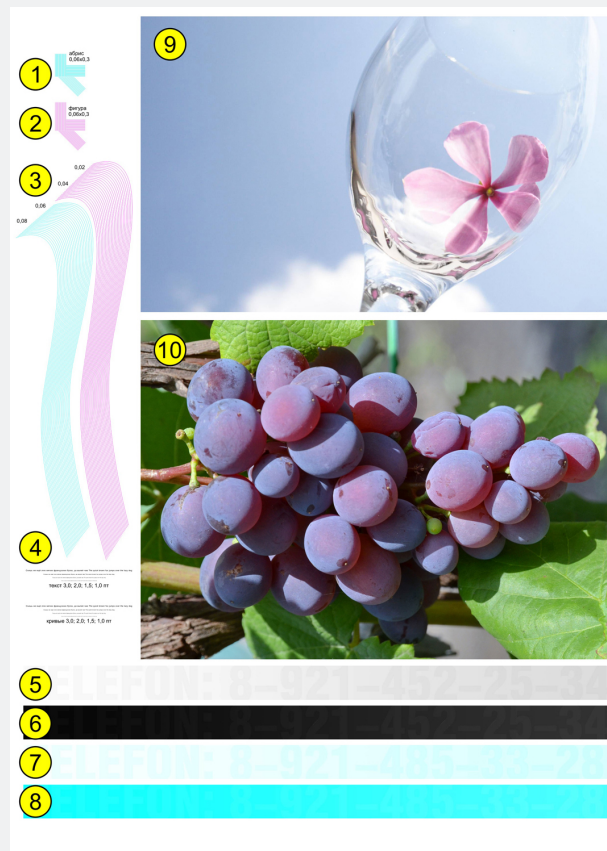
Рис. 1. Тест проверки качества печати лазерного принтера в зависимости от его разрешения
