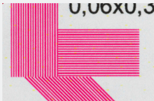
Рис. 3. Konika-Minolta C220: 1800x600 dpi - заметна разная толщина линий.
