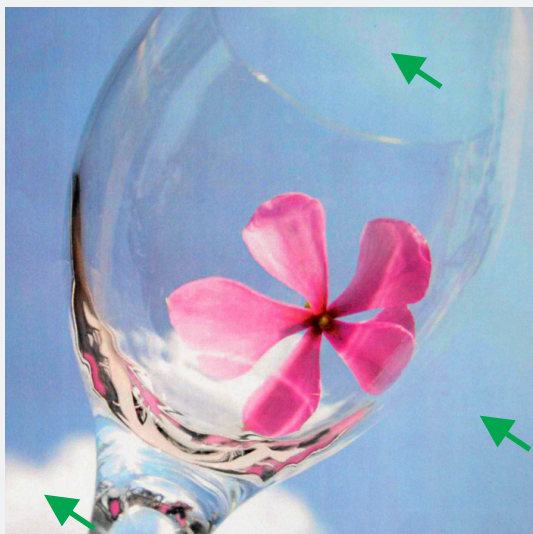
Рис. 8. Konika-Minolta C220: Заметны ступени полутоновых градаций, искажения оттенков цвета.
