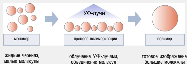
Рис. 7. Схема полимеризации УФ-чернил
